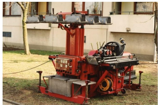
Absetzbehälter Lichtmast/Stromerzeuger von Knurz für das Kettensystem
