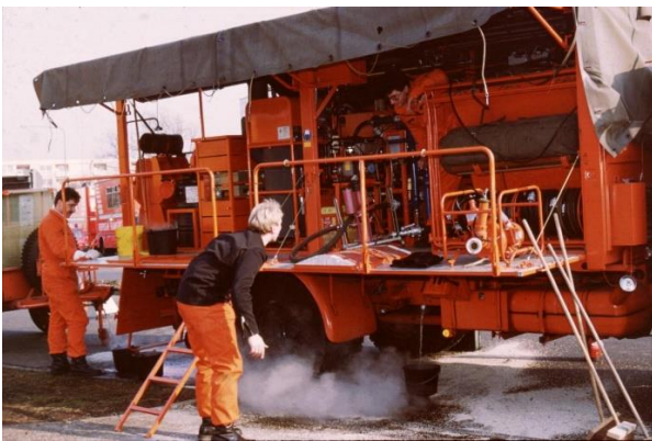
Das Dekontaminations-Mehrzweckfahrzeug (DMF) der Berufsfeuerwehr im Einsatz
