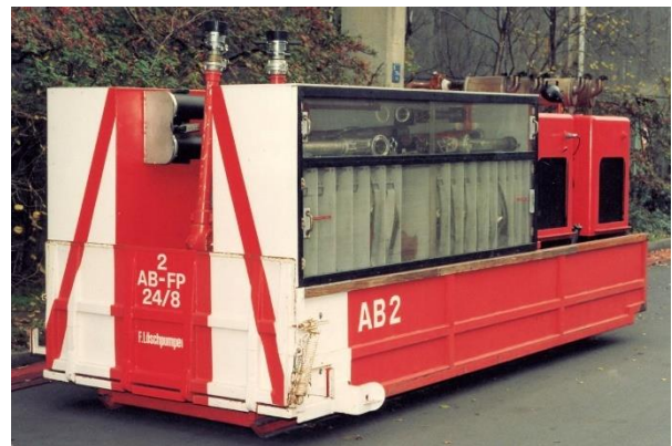
Absetzbehälter Feuerlöschpumpen für das Ruthmann-Absetzsystem
