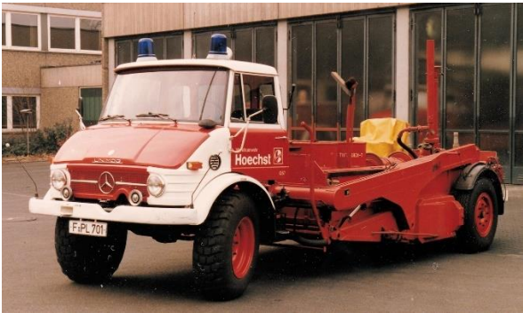
Der zweite Unimog-Triebkopf mit Aufbau „Schaum-Wasser-Werfer (führt auch Schläuche und Tutogen mit)“
