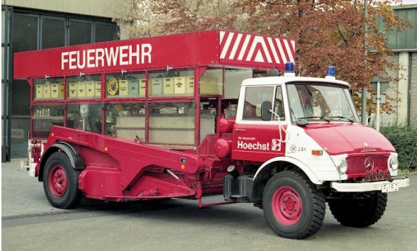
Mercedes Benz Unimog / Ruthmann WLF mit Aufbau „Gewässerschutz“
