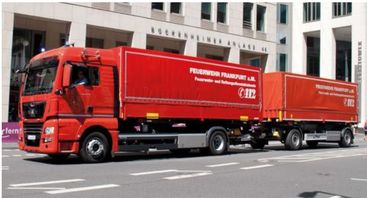
Gerätewagen GW-Fahrschule der BF Frankfurt, Baujahr 2018, MAN TGX 18.240 4x2 LL mit XLX-Fahrerhaus, Anhänger Fliegl, Typ ZWP 180
