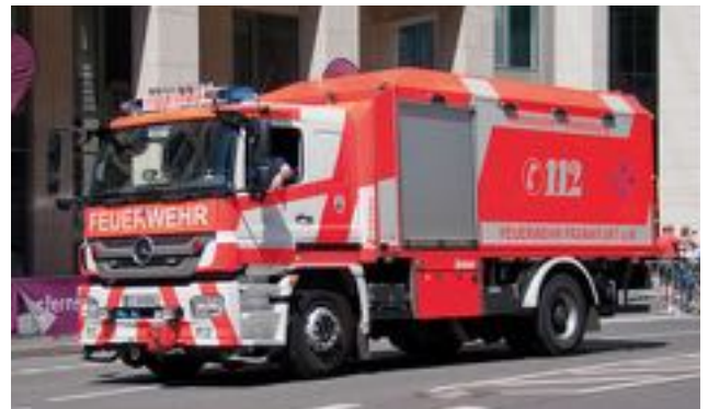
Rüstwagen RW-Schiene 1 der BF Frankfurt, Baujahr 2012, Mercedes Benz Axor1829, Aufbau Lentner
