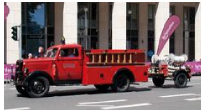
Opel Blitz, Baujahr 1939 (1,5 t, 6 Zylinder, 55 PS) aus Privatbesitz mit Kraftzugspritze KzS 8 aus dem Feuerwehr Museums Rhein-Main
