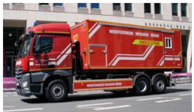
Wechselladerfahrzeug der WF InfraServ Frankfurt, Baujahr 2018, Mercedes-Benz Arocs 2643, mit Abrollbehälter Einsatzleitung
