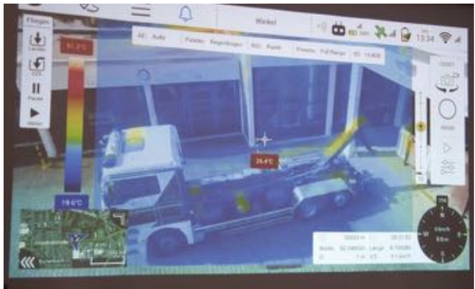
Die Bewegtbilder lassen sich »live« in den ELW 2 übertragen. Dabei kann die Infrarot-Anzeige der Wärmebildkamera über das »normale« Bild gelegt werden. Außerdem wird der jeweilige »Geländeausschnitt eingeblendet
