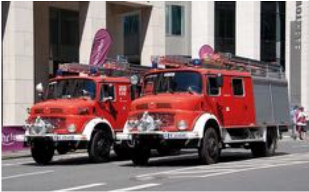
Löschgruppenfahrzeuge LF 16 TS der FF Frankfurt-Niederursel und -Schwanheim, Baujahr 1990, Mercedes-Benz LAF 1113 B, Aufbau Wackenhut
