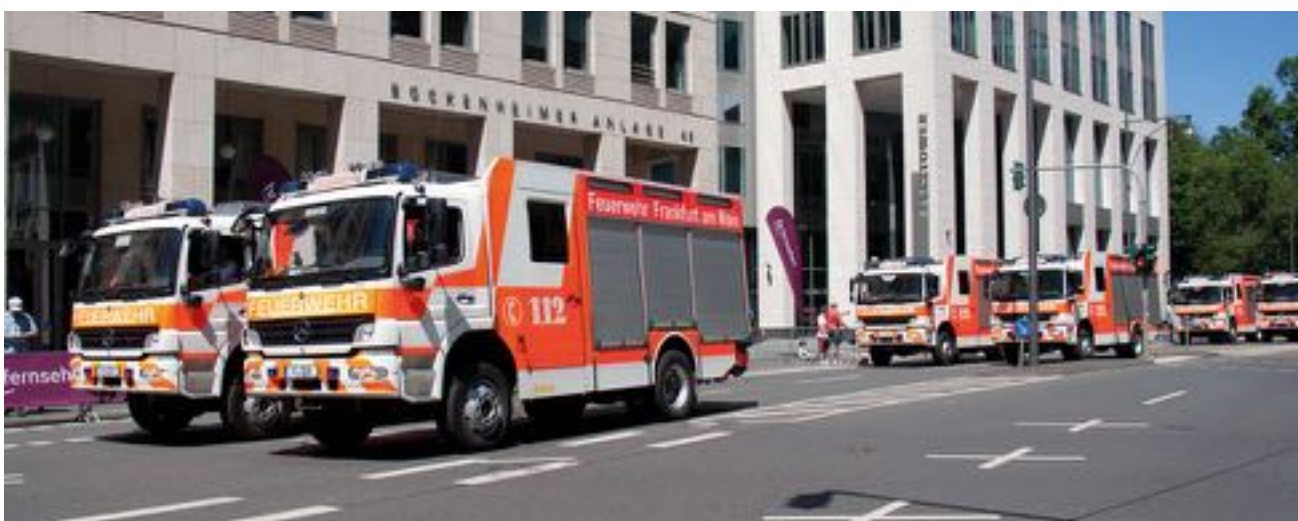
Löschgruppenfahrzeuge LF 20 der FF Frankfurt, Baujahr 2005, Mercedes-Benz Atego 1428 AF, Aufbau Lentner
