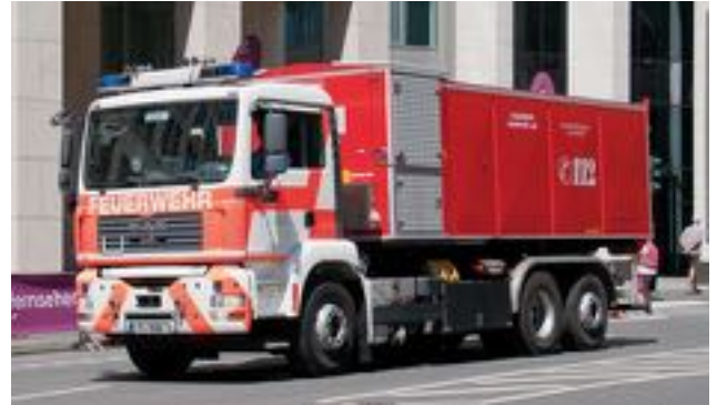
Wechselladerfahrzeug der BF Frankfurt, Baujahr 2005, MAN TGA 26.390 6x2LL, Aufbau Palfinger mit Abrollbehälter Löschwasserversorgung, Baujahr 2017, Hersteller Hytrans HFS
