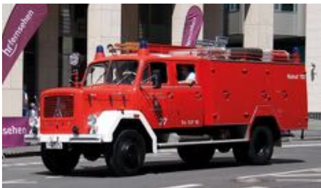
Trockentanklöschfahrzeug TroTLF 16 der FF Eppstein-Vockenhausen, Baujahr 1973, Magirus 150 D 11, Allradfahrgestell, Aufbau Magirus
