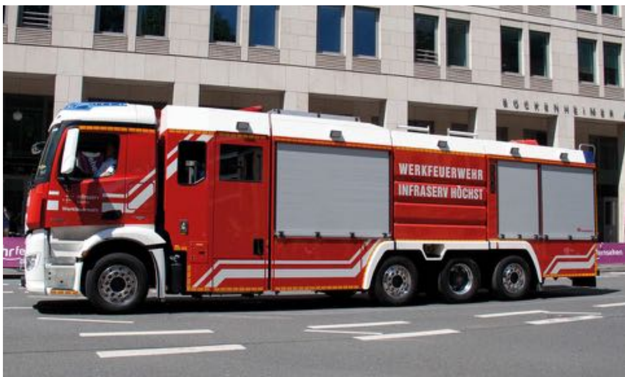
Trockentanklöschfahrzeug TroTLF 10 000/3 000/4 000/750/180 der WF InfraServ Frankfurt, Baujahr 2016, Mercedes-Benz Antos 3551 L 8x2, Aufbau Rosenbauer
