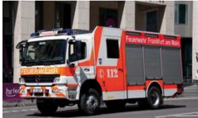
Löschgruppenfahrzeug LF 20 der FF Frankfurt, Baujahr 2005, Mercedes-Benz Atego 1428 AF, Aufbau Lentner
