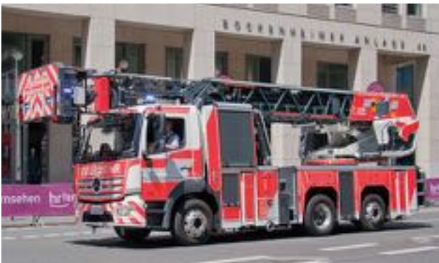
Hubrettungsfahrzeug DLK23/12 der BF Frankfurt, Baujahr 2018, Mercedes Benz Atego 1530 F 6x2*4 MB 967, Aufbau Rosenbauer
