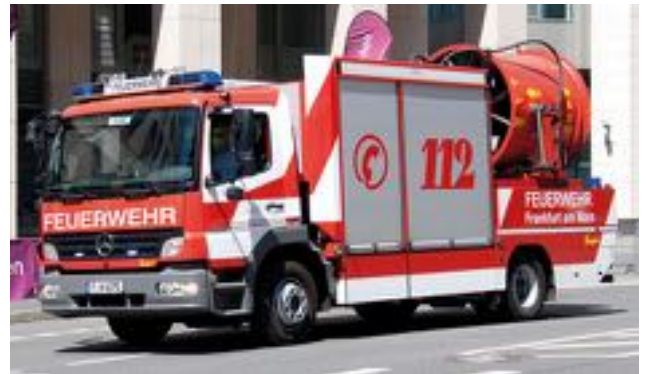
Gerätewagen GW-Lüfter (mobiler Großventilator – MGV) der BF Frankfurt, Baujahr 2009, Mercedes Benz Atego 1324 L 4x2, Aufbau Ziegler
