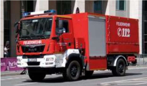
Schlauchwagen SW-KatS der FF Frankfurt-Eschersheim, Baujahr 2016, MAN TGM 13.250 4x4, Aufbau Freytag
