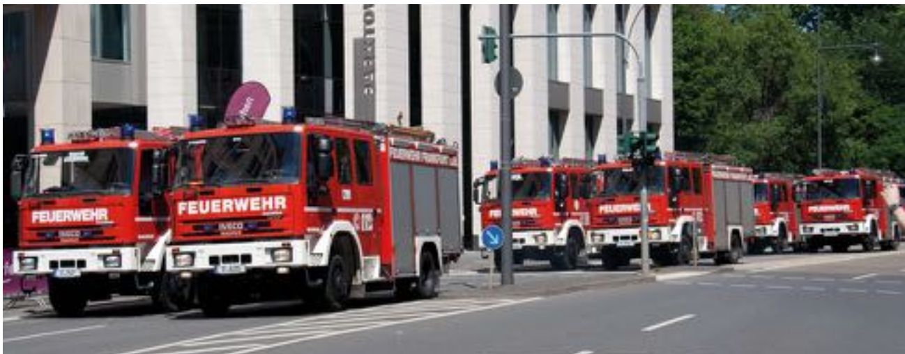
Löschgruppenfahrzeuge LF 10/6 der FF Frankfurt, Baujahr 2004, Iveco Magirus 100 E 21 W, Aufbau Magirus
