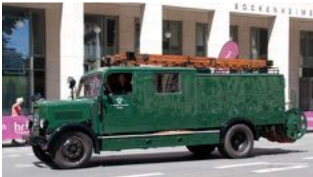
Schweres Löschgruppenfahrzeug (LF 15), der FF Idstein auf Mercedes-Fahrgestell, Baujahr 1942
