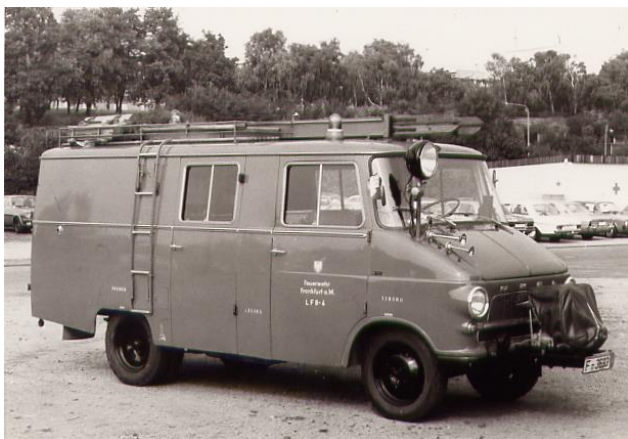
LF 8 auf Fahrgestell Opel Blitz mit Heckbeladung, Aufbau Magirus, Freiwillige Feuerwehr Harheim, zeitweise auch in Höchst eingesetzt
