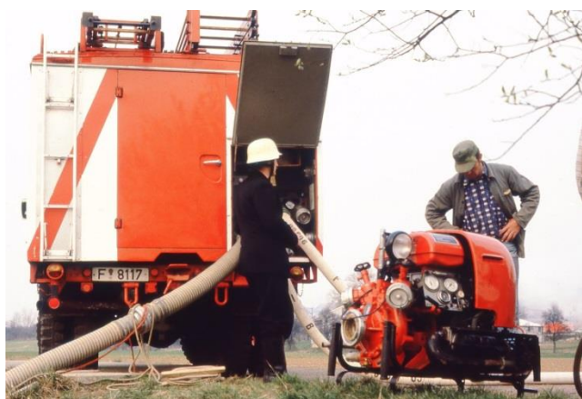
LF 16-TS der FF Frankfurt a.M. im Einsatz. Deutlich erkennbar ist der am Heck nach rechts versetzte, mit einer Klappe verschlossene Pumpenbedienstand
