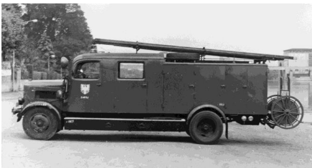
SLG (LF 15) auf Mercedes-Fahrgestell. Nach dem Krieg weiter verwendet; nun mit Rundumkennleuchte.
