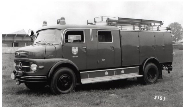
Mercedes Benz / Metz LF 16 für die Berufsfeuerwehr. Die Motorleistung beträgt nun 132 PS.
