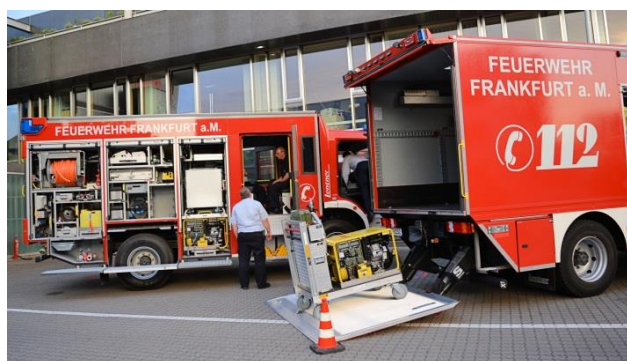
Links ein „normales“ LF 10/6 von Lentner; rechts das LF 10-Logistik mit offenem Heck-Geräteraum
